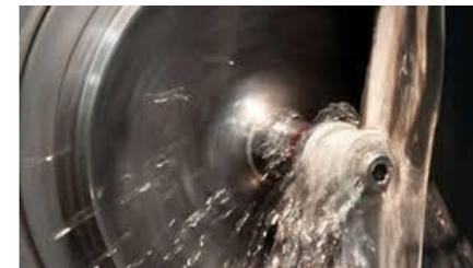
Usinage de  $\text{Si}_3\text{N}_4$
