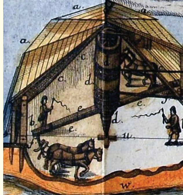
A só felszínre hozását biztosító gépezet középkori sóbányákban (Draskóczy István dolgozata nyomán). Mechanism for lifting salt in medieval salt mines (by István Draskóczy).
