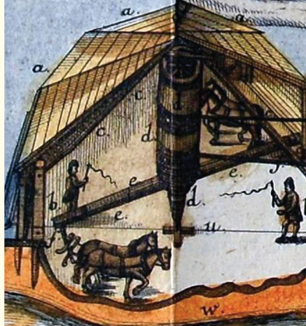
Механізм для підняття солі в середньовічних соляних шахтах (за Іштваном Драшкочі). Mechanism for lifting salt in medieval salt mines (by István Draskóczy).
