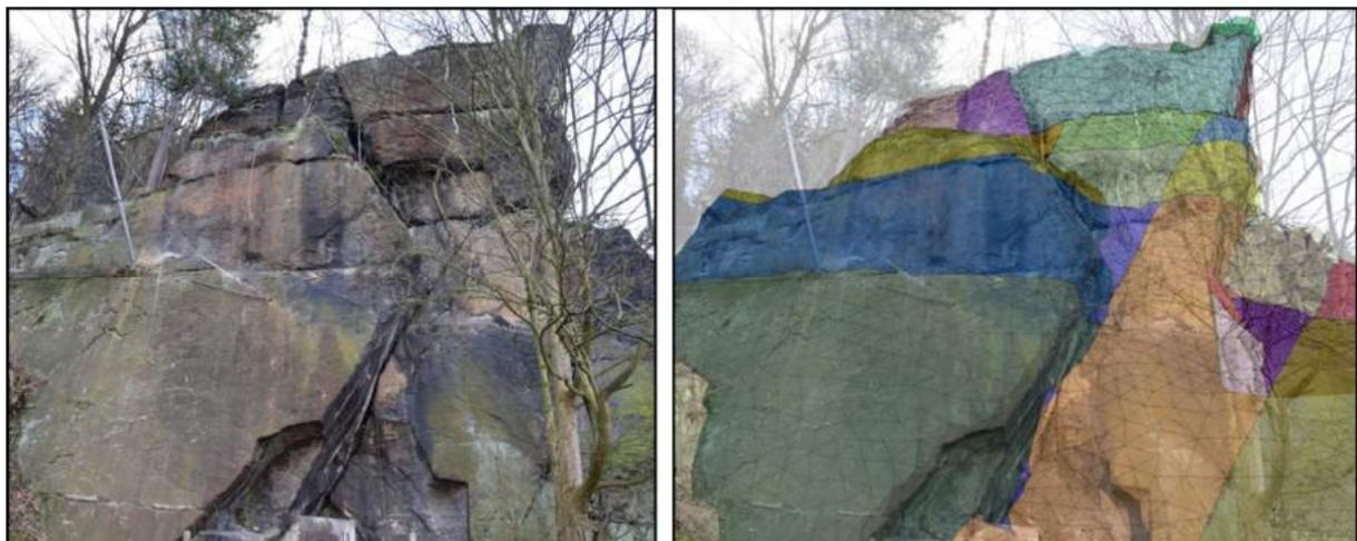
Abb. 4.10: SO-Ansicht des Blockmodells mit Geländefoto überlagert (Geländefoto Quelle: J. WICHERT)
