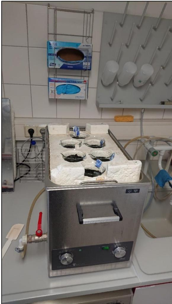
Abbildung 42: Ultraschalldispersion der Bodenproben.
