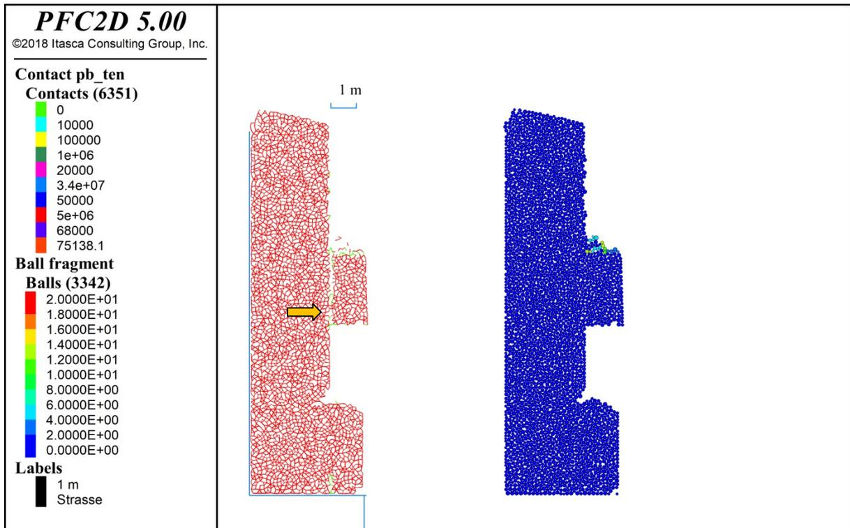
**Abb. 47** Sturzzenario D nach 15 Verwitterungsschritten – Detail
