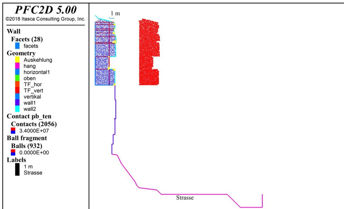
**Abb. 34** Ausgangsmodell in der 1000-Bälle-Version (rechts in rot noch einmal verschoben der mit Bällen gefüllte Bereich zur Darstellung der Fragmente, links: gelb – Auskehlung, rot - Trennflächen)
