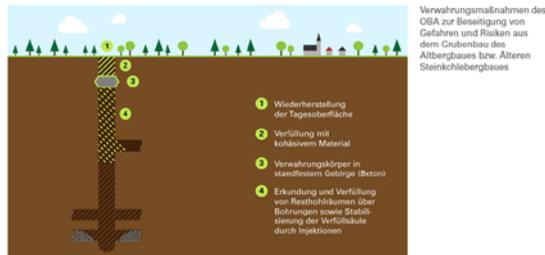
Im Nachgang wird die locker gelagerte Schachtfüllsäule mittels tiefer Bohrung (100 m) erkundet und bewertet. Resthohlräume werden umgehend während der Bohrarbeiten mit Beton verfüllt. Nach dem Ausbau der Bohrungen wird die Füllsäule durch Injektionen mit Zementsuspension stabilisiert.
