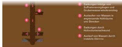
Bewegung in der instabilen Schachtfüllsäule führen zu einem Verbruch an der Tagesoberfläche
