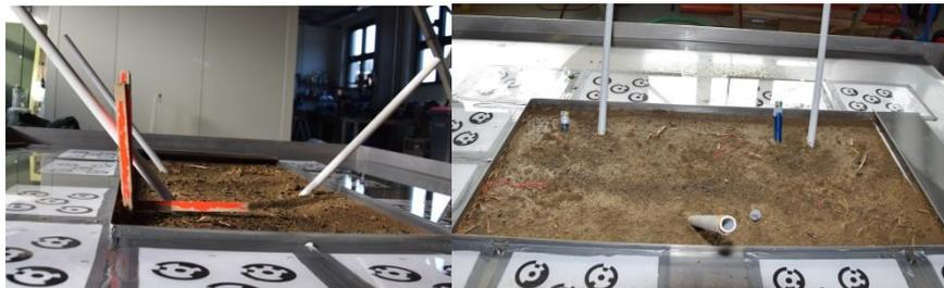
Abbildung 1: Die Bodenoberfläche des Bodenmonoliths für die Regensimulation; links: Einmessen des 45 Grad Winkels; rechts: die Bodenoberfläche nach der Regensimulation.
