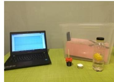
Wenn man den Wert der vertikalen Beschleunigung in einer frei fallenden Schachtel überprüft, wird man feststellen, dass die Kraft, die auf die Schachtel wirkt, von Null an ständig wächst. Wird die Größe der waagerechten Fläche der Schachtel verändert, nimmt die Kraft, die auf die Schachtel wirkt, bei größerer Fläche schneller zu. Diese Wirkung hängt eindeutig vom Luftwiderstand ab.
