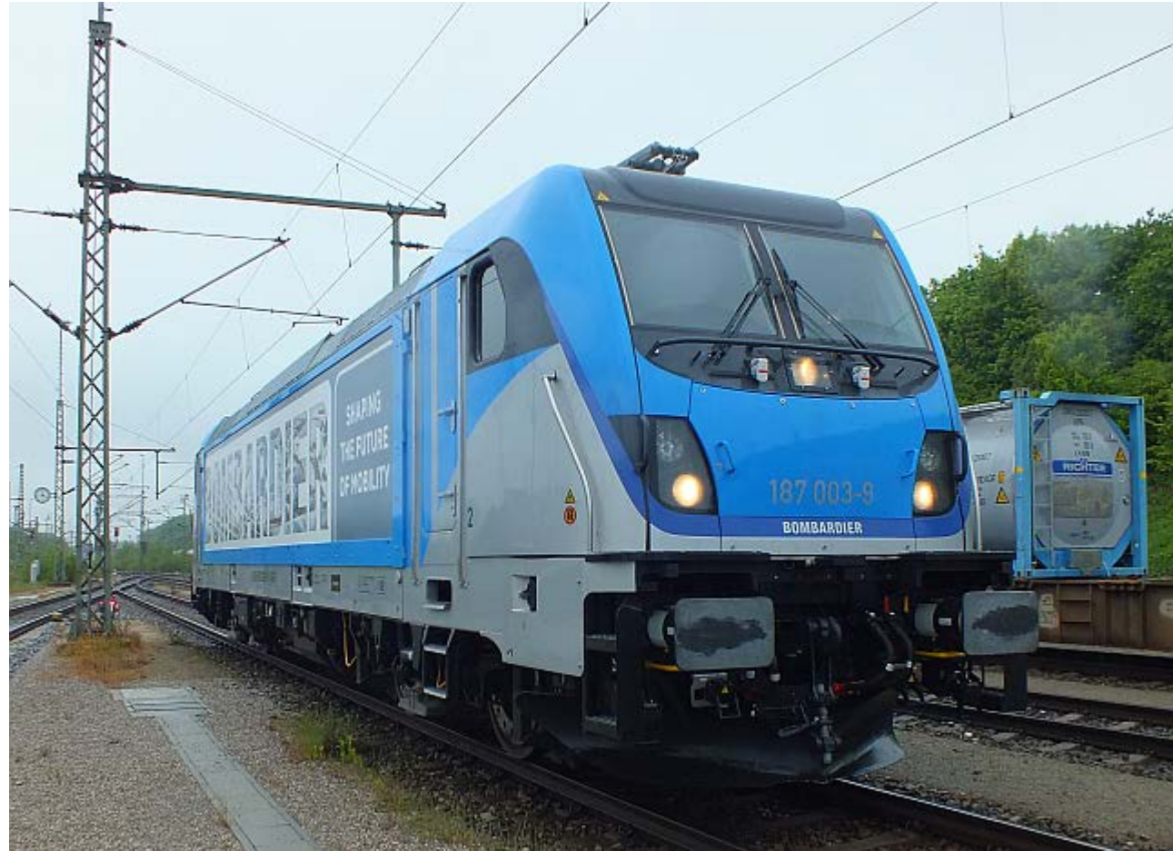
Bombardier TRAXX3 mit Last Mile Funktionalität Quelle: eigene Abbildung
