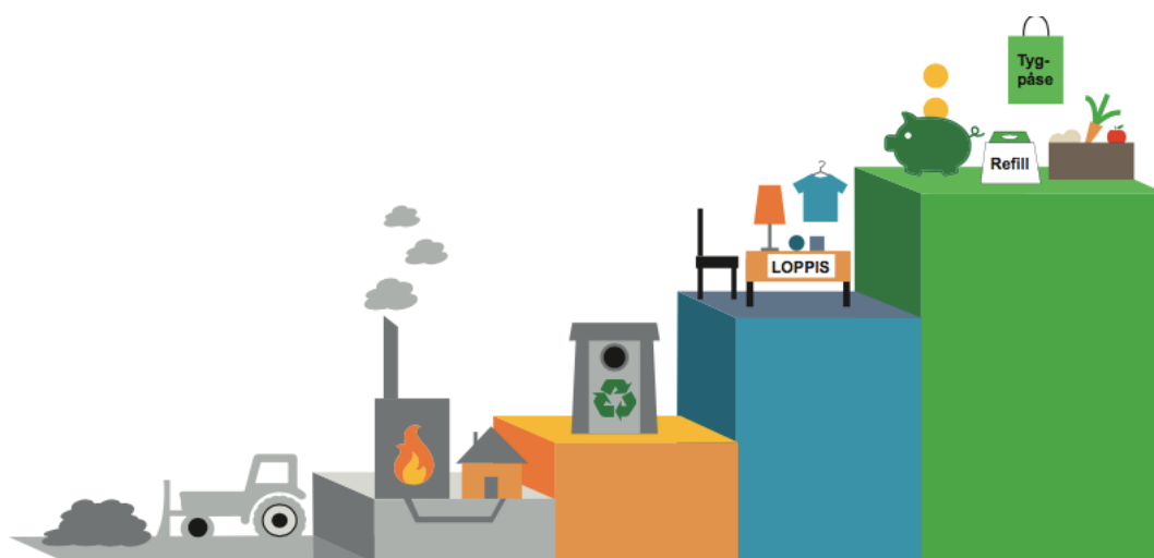
Figur 1. Avfallshierarkin, eller avfallstrappan, visar prioriteringsordningen för hur avfall ska hanteras och behandlas för minimerad miljöpåverkan.
