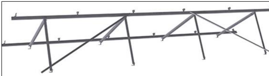
Ilustración 17. Ejemplo de estructura para placas fotovoltaicas en cubiertas planas
