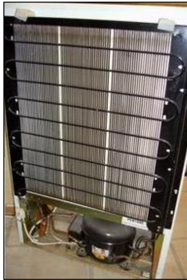
Ilustración 20. Parte trasera de un frigorífico.
