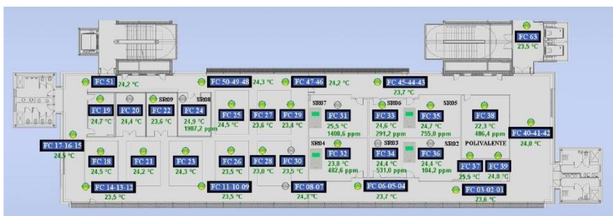
Ilustración 19. Ejemplo de un Sistema de Control Centralizado para climatización (Fuente: Creara)
