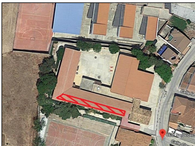
Ilustración 14. Zona óptima para la ubicación de las placas fotovoltaicas
