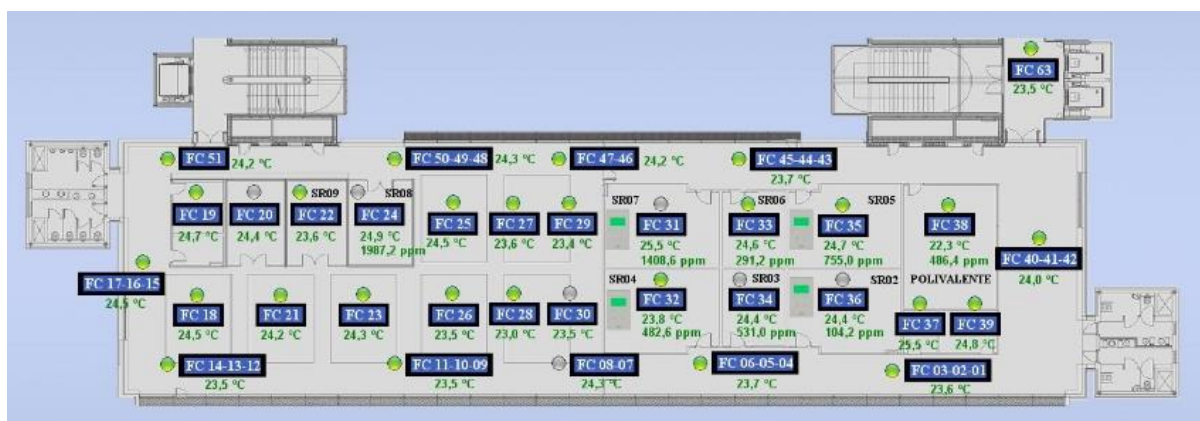
Ilustración 19. Ejemplo de un Sistema de Control Centralizado para climatización
