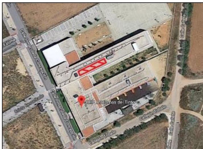
Ilustración 13. Zona óptima para la ubicación de las placas fotovoltaicas
