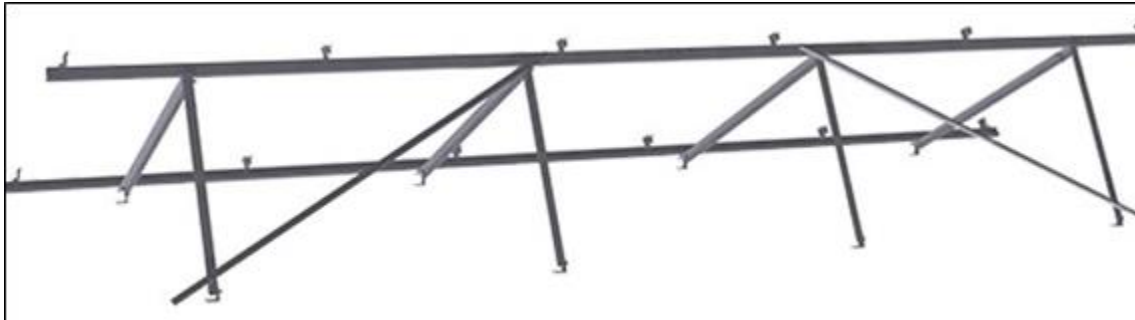
Ilustración 14. Ejemplo de estructura para placas fotovoltaicas en cubiertas planas
