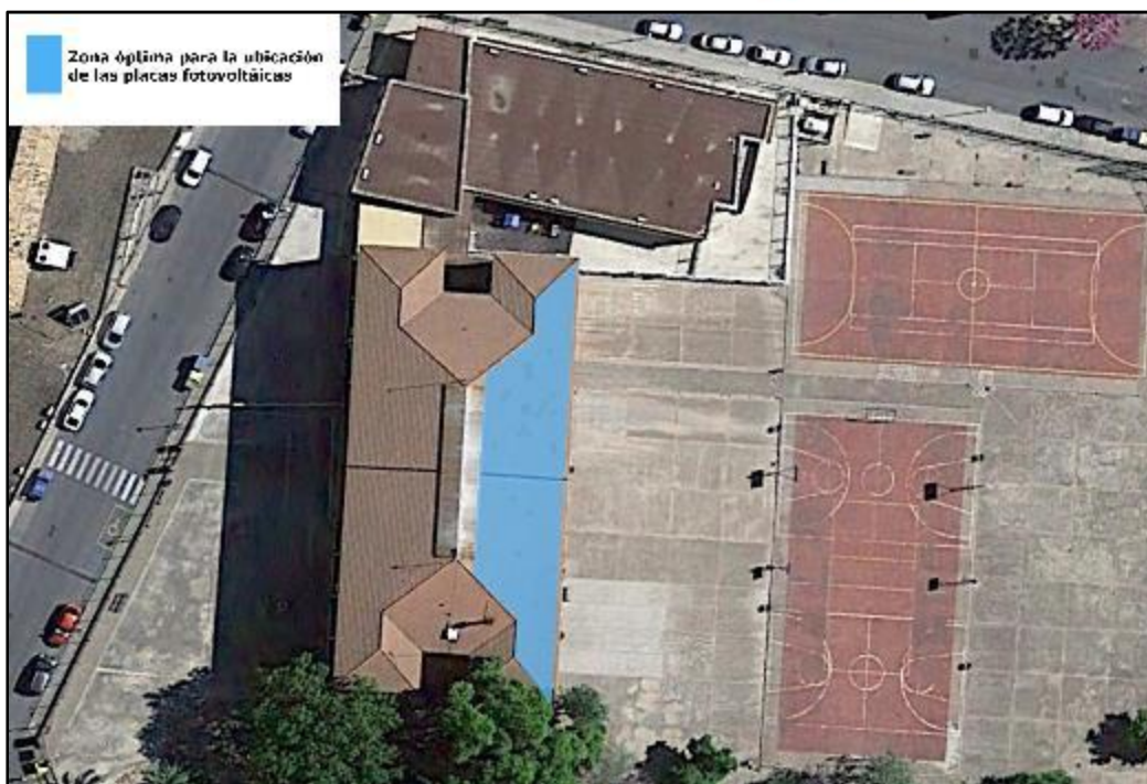
Ilustración 18. Zona óptima para la ubicación de las placas fotovoltaicas
