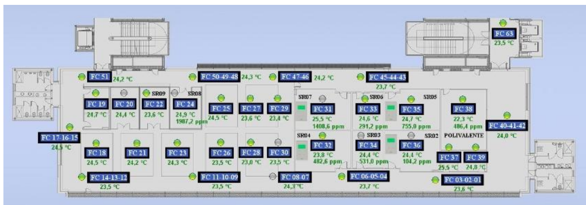
Ilustración 24. Ejemplo de un Sistema de Control Centralizado para climatización (Fuente: Creara)
