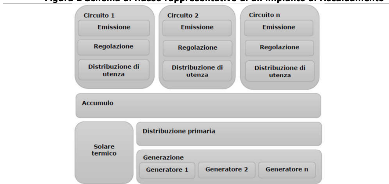
Figura 2 Schema di flusso rappresentativo di un impianto di riscaldamento
