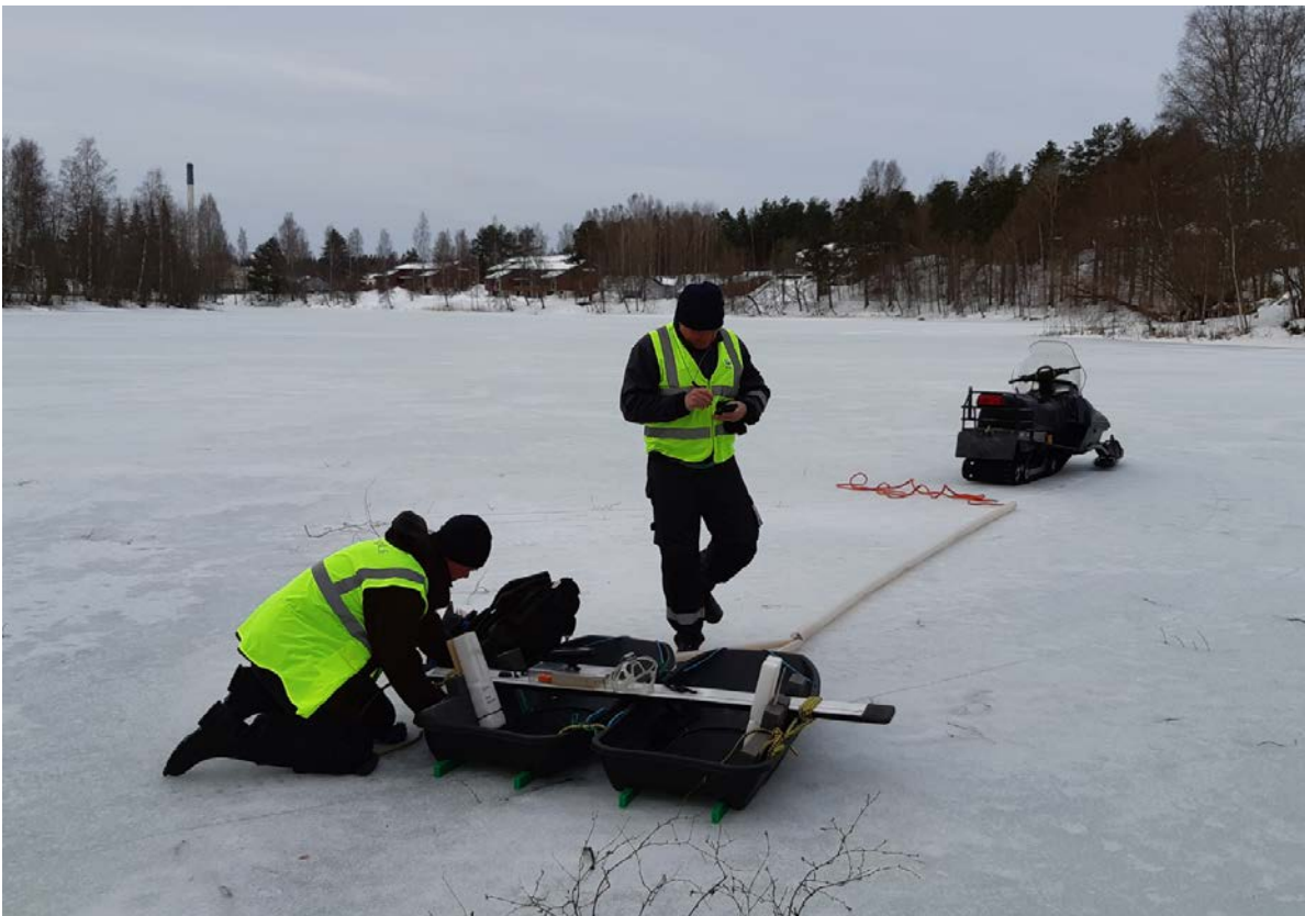
Kuva 5. GEM-2 –mittausta Likolammella. Kuva A. Kiiskinen, GTK
