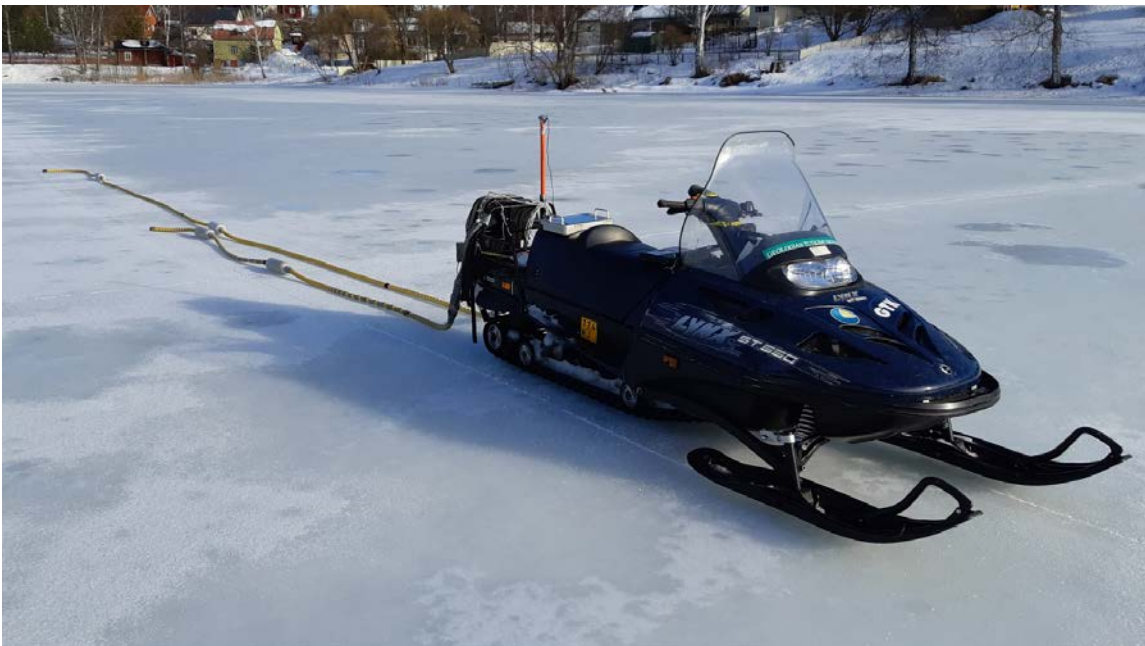
Kuva 3. Maatutkaluotauskalusto Likolammella. Kuva A. Kiiskinen, GTK.
