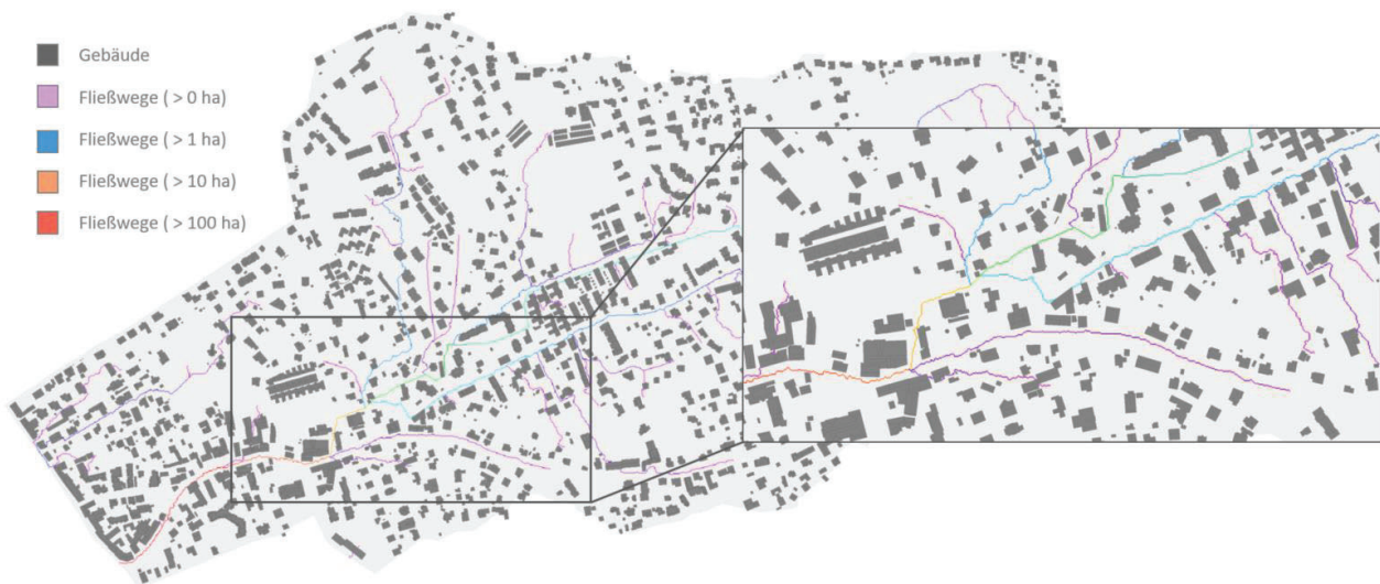
Abbildung 30: Ergebnis aus der topographischen Fließweganalyse (Einteilung in 4 Abflussakkumulationsklassen)
