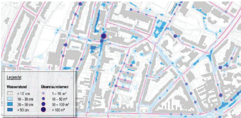
Abbildung 13: Gekoppelter 1D-2D Modellansatz zwischen 1D Kanalmodell und 2D Oberflächenabflussmodell (DWA-M 119, 2016)
