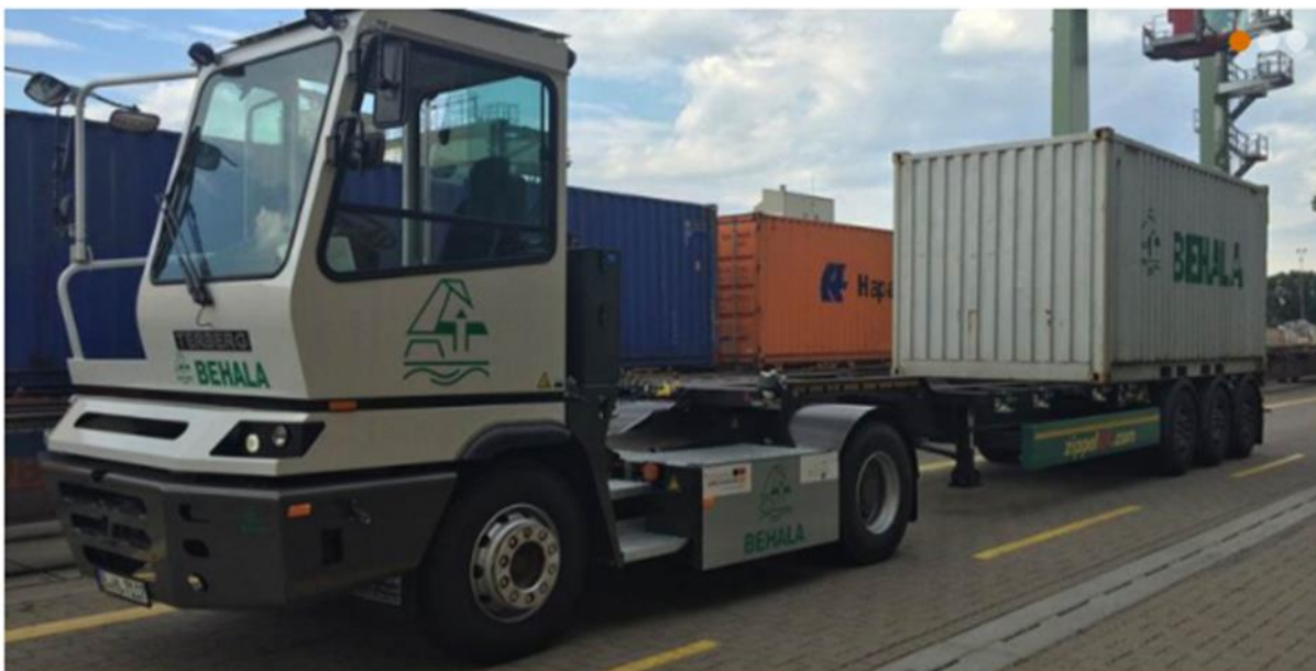
Rysunek 3 Pojazd bateryjny testowany do transportu ładunków w ramach ostatniej mili (projekt KV-E-CHAIN), źródło: Combined transport
