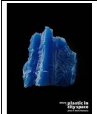
Зажигалка Реальный размер: 5 мм Материал: ацеталь/ полиоксиметилен (ПОМ)
