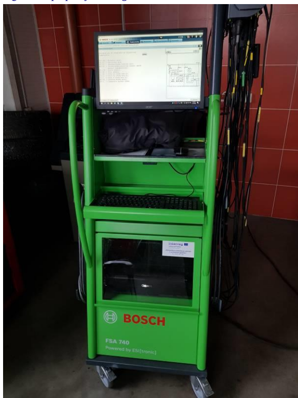
Foto 41. Zakupiony system do diagnozowania samochodów
