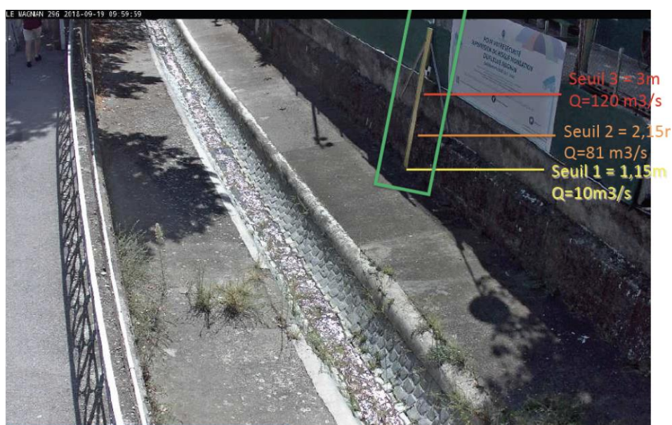
Figure 49 : Seuils de mesure de hauteur et de prévision de débits pour le site aval
