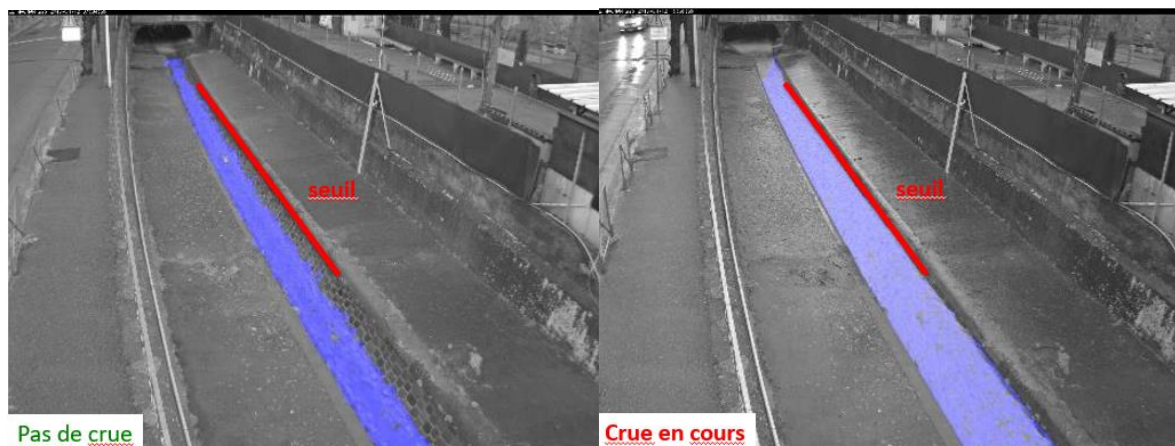
Figure 19 : Détection automatique de seuils sur les surfaces en eau permettant notamment la diffusion d'alertes lorsque l'écoulement sort de la cunette sur le site aval, c'est à dire bien avant que le niveau atteigne le bas de l'échelle utilisée pour la mesure de hauteurs
