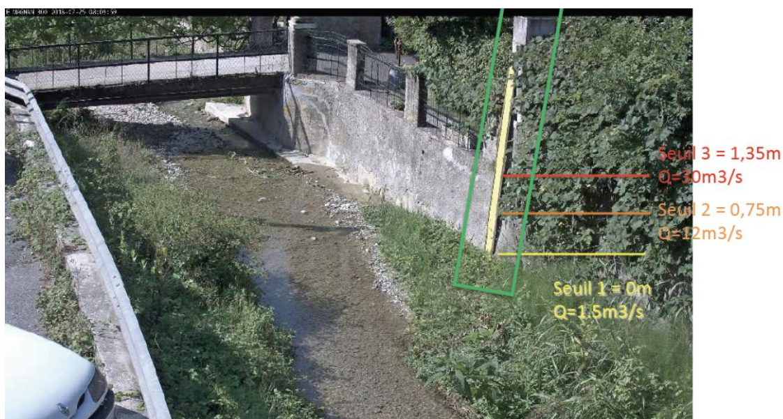
Figure 48 : Seuils de mesure de hauteur et de prévision de débits sur le site médian
