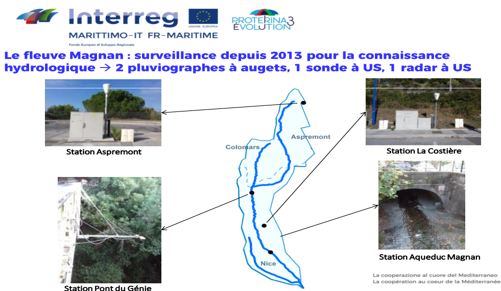
Figure 7 les 4 types de capteurs pré-existants.
