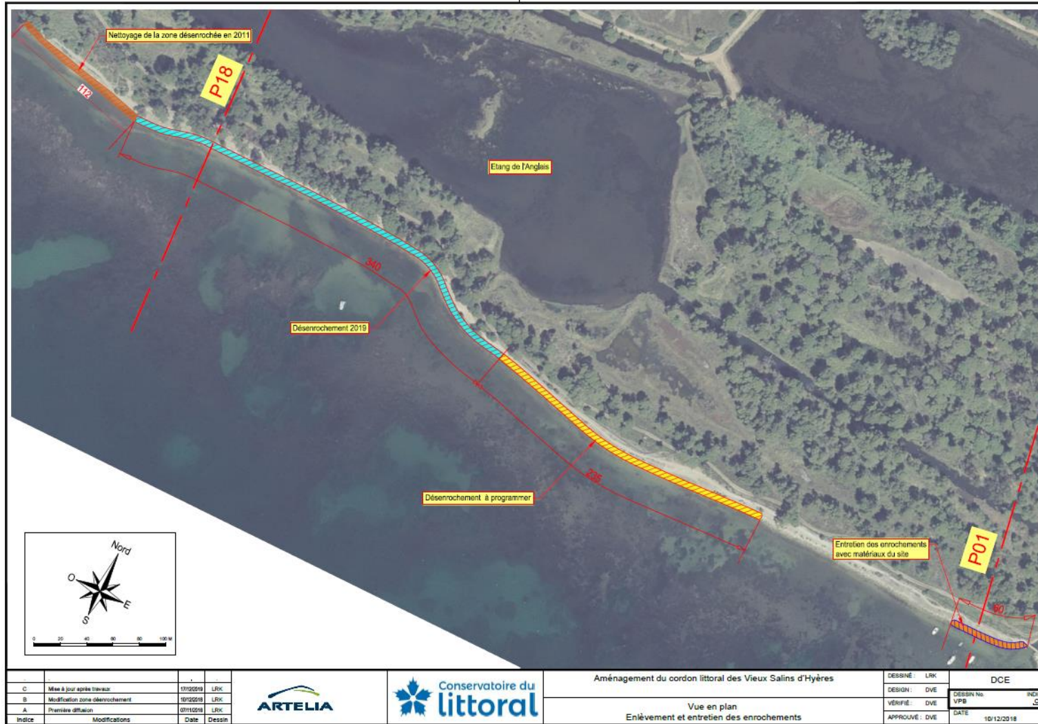
Figura 3: Piano di lavoro per la rimozione e la manutenzione di Riprap
