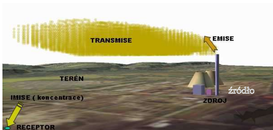
Rys.4.11 Dyspersja zanieczyszczeń powietrza [4.12]
