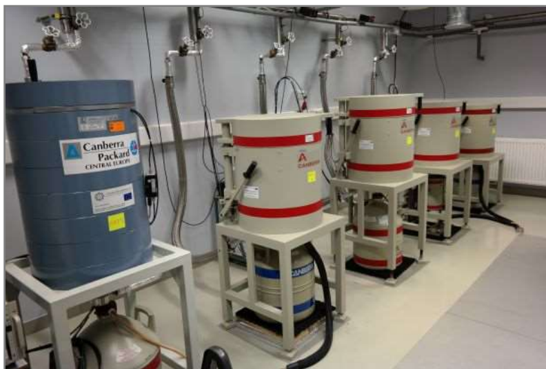
Rys. 5.29 Spektrometry promieniowania gamma HPGe w niskotłowych domkach ołowianych (foto: autor)
