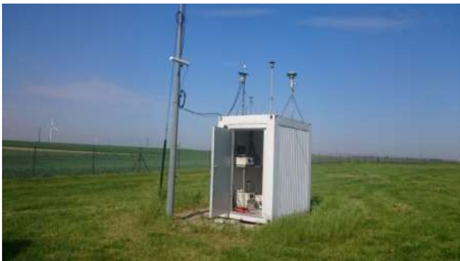
Rys. 5.19 Stacja pomiarowa w Raciborzu z spektrometrami cząstek SMPS i APS na stanowisku (foto: autor)
