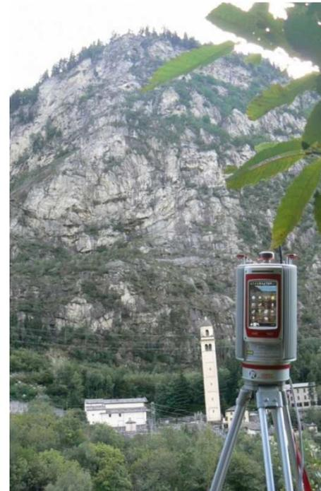
Verranno fatte numerose scansioni con strumenti LaserScanner *Long Range* (con portate fino a 2-4 Km) per ottenere una **descrizione 3D della costa** ad alto livello di dettaglio.
