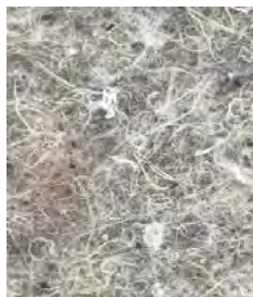
Włóknina wyprodukowana z: 33% rozwłóknionej krajki jutowej 33% krajki polipropylenowej 34% szarpanka - poliester z pikowanych odpadów włókienniczych
