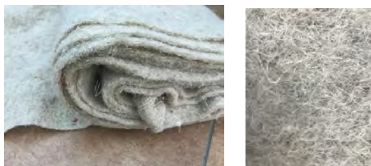
Włóknina wyprodukowana z: 33% rozwłóknionej krajki jutowej 33% krajki polipropylenowej 34% szarpanka - poliester z pikowanych odpadów włókienniczych
