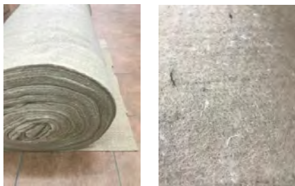
Włóknina wyprodukowana z: 50% rozwłóknionej krajki jutowej 50% krajki polipropylenowej
