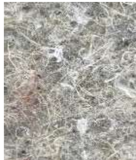
Włóknina wyprodukowana z 100% rozwłóknionej krajki jutowej
