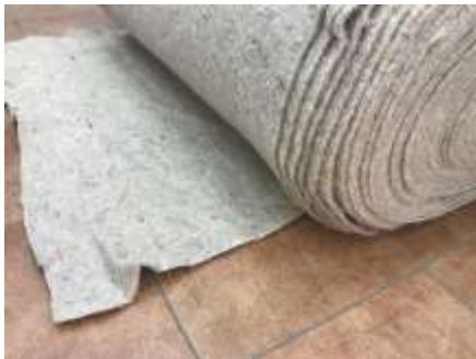
Włóknina wyprodukowana z 100% rozwłóknionej krajki jutowej
