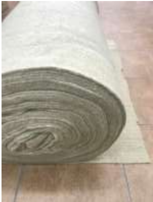
Włóknina wyprodukowana z 100% rozwłóknionej krajki jutowej
