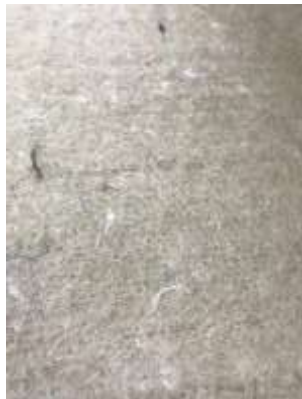
Włóknina wyprodukowana z 100% rozwłóknionej krajki jutowej
