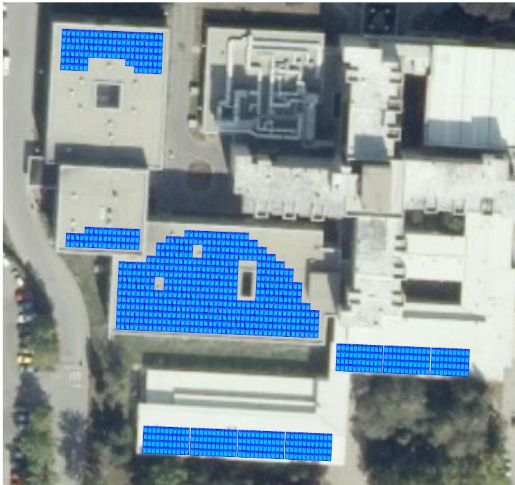
Slika 27 Dispozicija fotonaponskih modula na krovu bolnice
