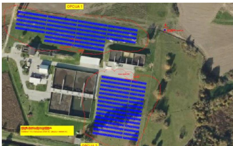
Slika 41 Dispozicija sunčane elektrane
