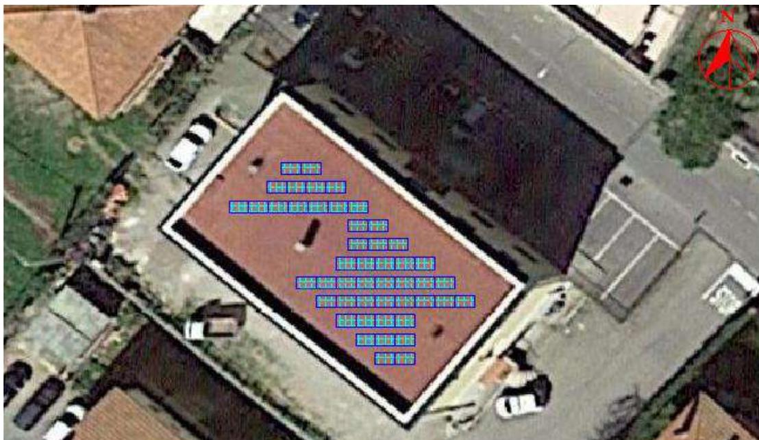
Figura 5: Disposizione dei moduli in copertura
