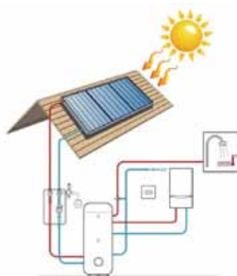
Figura 11: Schema impianto solare termico (Fonte: www.mondoenergia.net )
