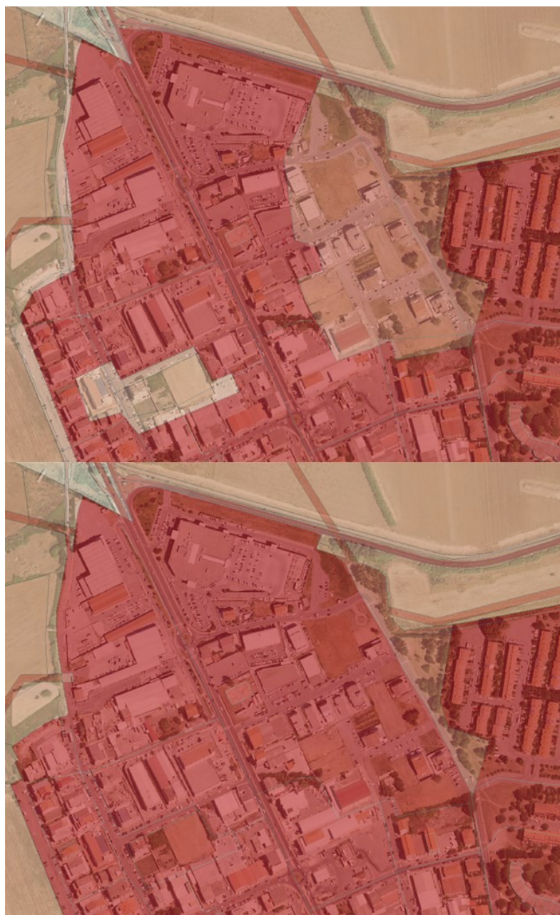
Figure 0.3 – En haut détail de la cartographie du PGRA des dommages potentiels (les tonalités de rouge de plus en plus foncées indiquent une augmentation des dommages potentiels) dans la zone de Porta Nuova, élaboration de la même zone produite par le Plan d’Adaptation. Dans la cartographie PGRA, une portion d’agglomération est classée parmi les zones agricoles (en bas à gauche avec une classe de
