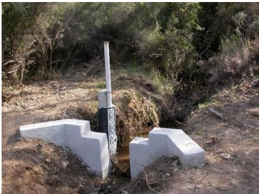
Figure 6.1 : Station hydrométrique sur le vallon de Meyffrey (Photo D. Fox).
