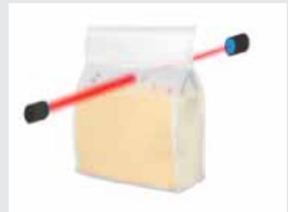
Figura 3. Esquematización de sistemas no destructivos basados en espectroscopia láser IR para la medición de gases.
