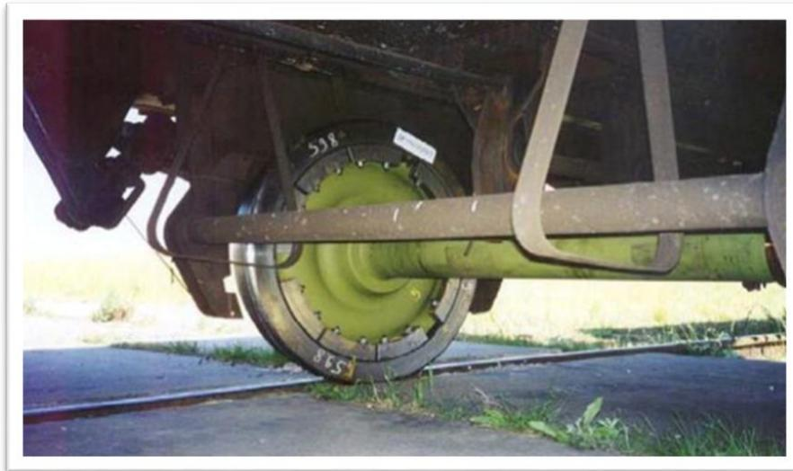
*Figure 13 Roues silencieuse con assorbente di vibrazioni*
