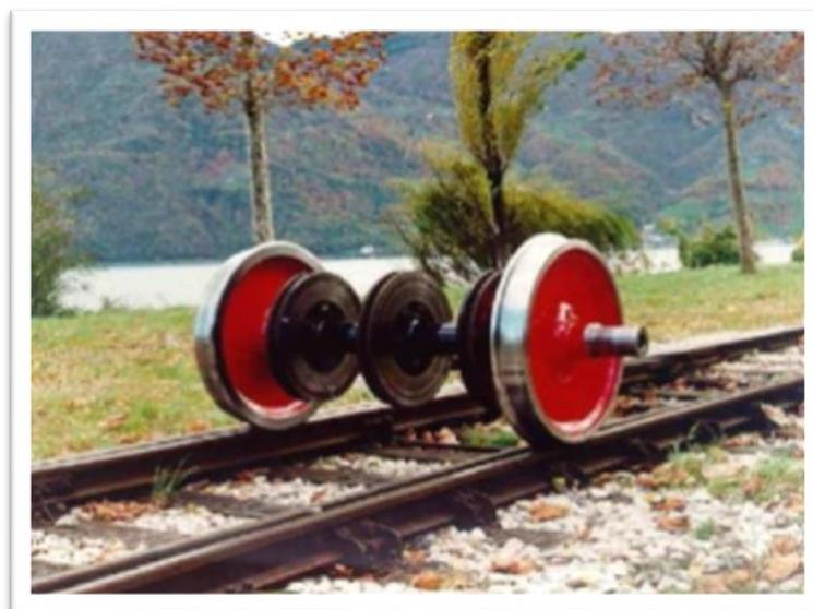
Figure 12 - Roues silencieuse avec matériel viscoélastiques
