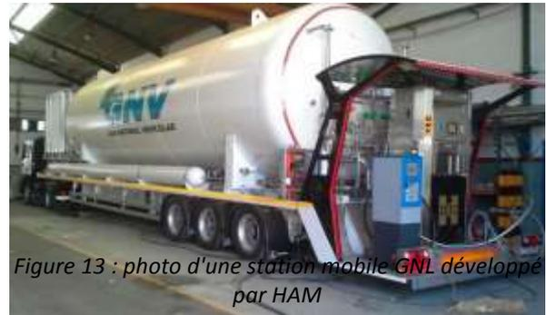
Figure 13 : photo d'une station mobile GNL développée par HAM
