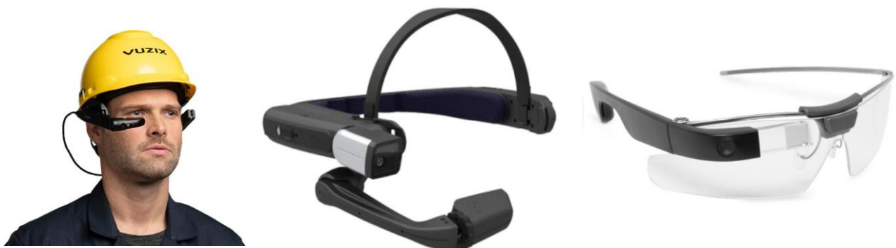
Figure 2 : Exemples de dispositifs portatifs à réalité augmentée avec projection des informations reçues sur des verres ou directement sur la rétine de l'opérateur. Source : sites Web des fabricants
