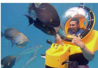
Un autre dispositif technologique pour un déplacement aisé dans l'eau est le scooter sous-marin. Il s'agit d'un dispositif qui, en plus de permettre le déplacement dans l'eau, crée un espace vital autour de la tête, ne nécessitant donc pas l'utilisation d'équipements de plongée.
