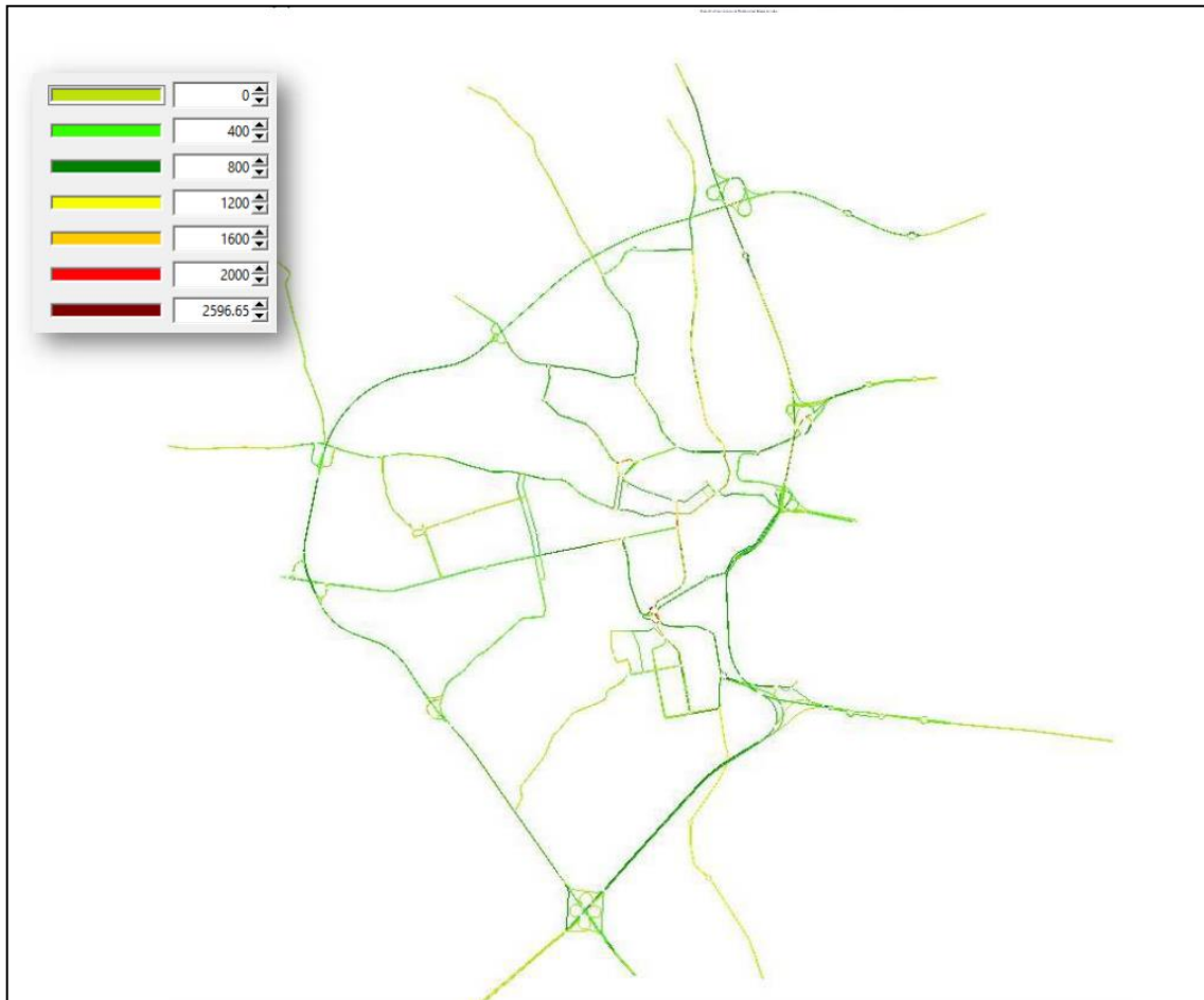
Figure II.23 Répartition des flux de trafic (véhicules/heure) à l'heure de pointe de l'après-midi d'été
