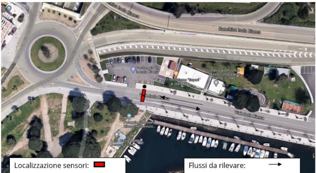
Figure III.6 – Détecteur de trafic n° 2 à Viale Isola Bianca
