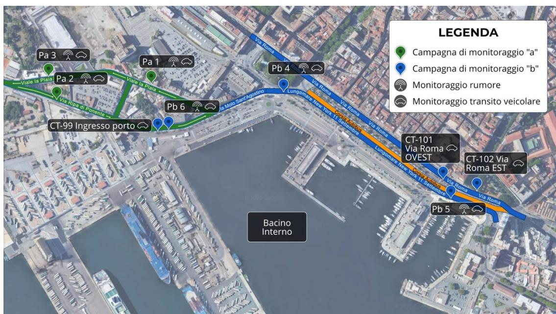
Figure 4 : Détail du réseau routier surveillé avec indication de la position des unités de surveillance acoustique et des compteurs de trafic. En vert les points de la partie « a » du suivi, en bleu les points relatifs à la partie « b » du suivi.
