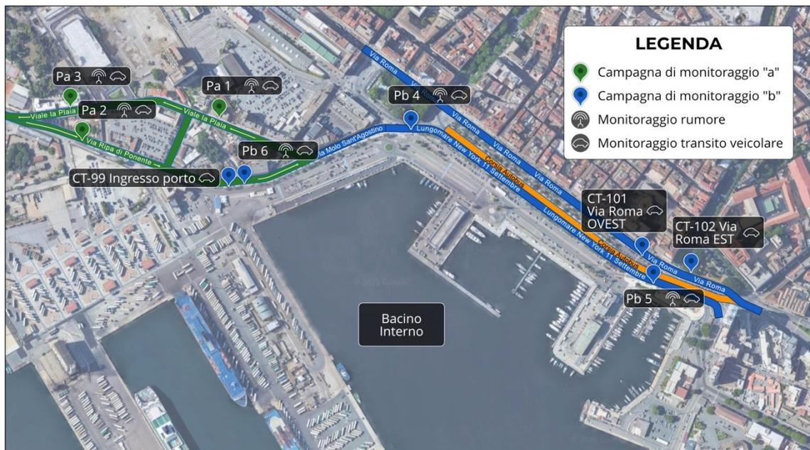
Figure 4 - Détail du réseau routier surveillé avec indication de la position des unités de suivi acoustique et des compteurs de trafic. En vert les points de la partie « a » du suivi, en bleu les points relatifs à la partie « b » du suivi.
