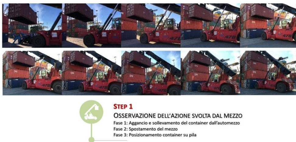
FIGURE III.5: ESEMPIO DI PROCEDURA DI MISURA E POST-ELABORAZIONE (STEP 1)
