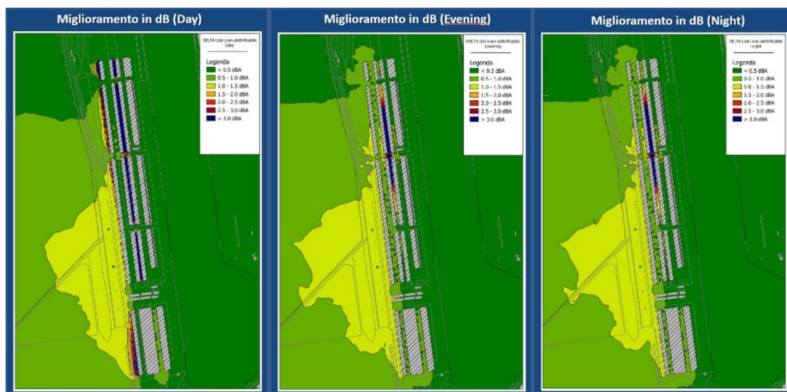
FIGURE III.15: SINTESI GRAFICA RISULTATI SOUNDPLAN (MAPPE ISOLIVELLO DI CONFRONTO)
