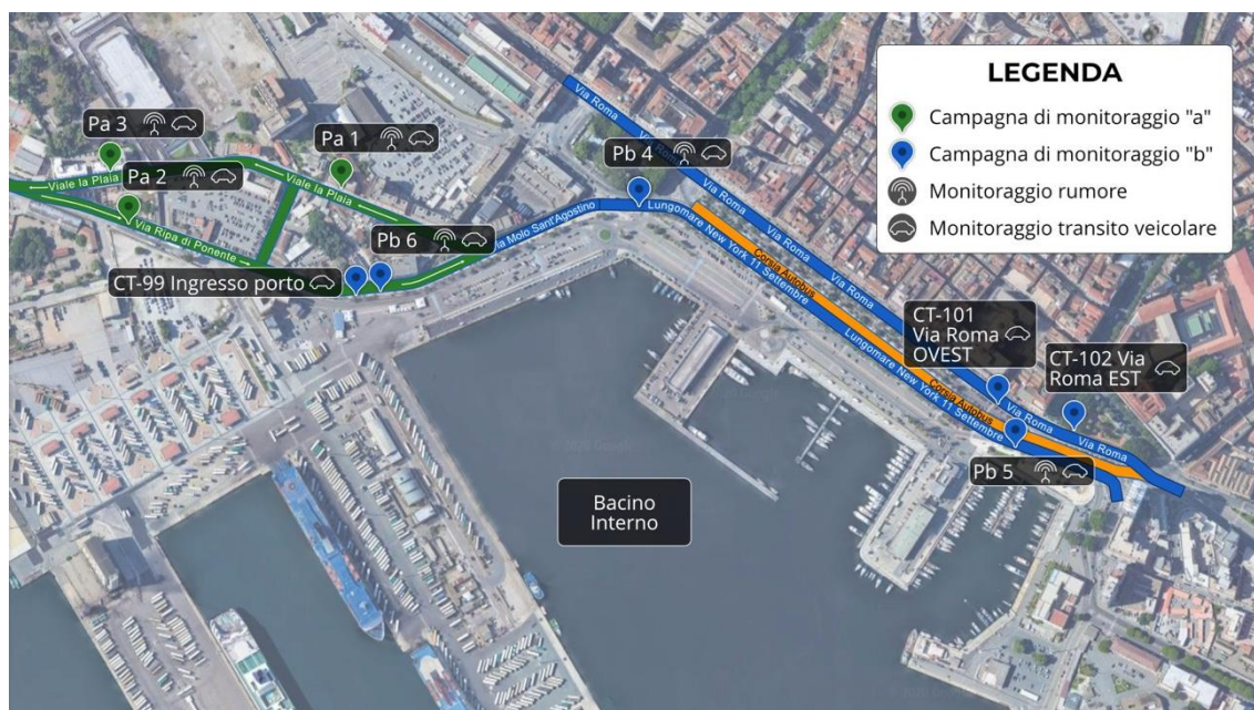
FIGURE II.32 DETAIL DU RESEAU ROUTIER SURVEILLE AVEC INDICATION DE LA POSITION DES UNITES DE SURVEILLANCE ACOUSTIQUE ET DES COMPTEURS DE TRAFIC. EN VERT LES POINTS DE LA PARTIE « A » DU SUIVI, EN BLEU LES POINTS RELATIFS A LA PARTIE « B » DU SUIVI.
