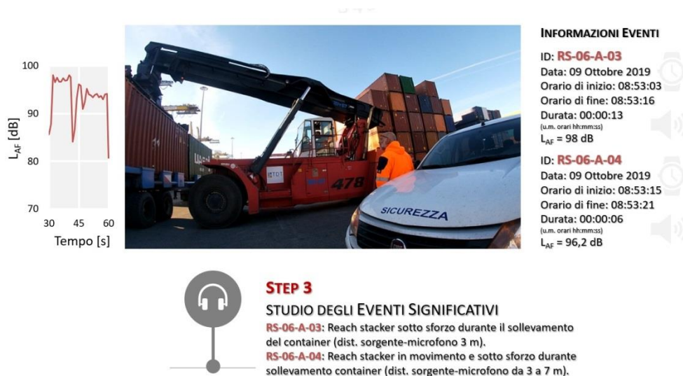
FIGURE III.7: ESEMPIO DI PROCEDURA DI MISURA E POST-ELABORAZIONE (STEP 3)
