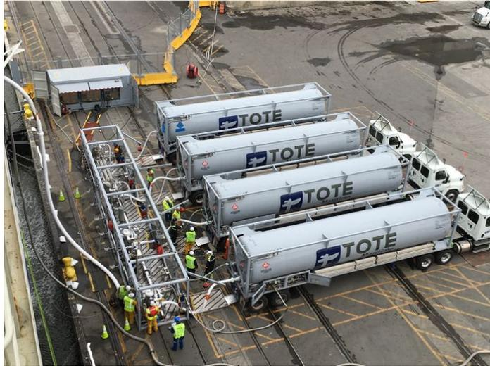
**Figure 5 - Exemple - Ravitaillement TTS indirect sur conteneur (Port de Jacksonville EU)**
