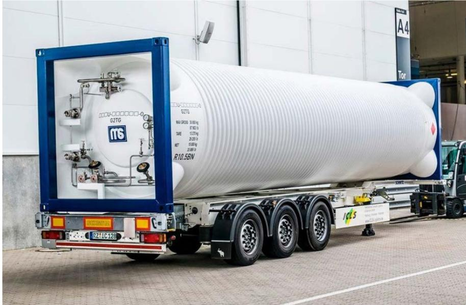
**Figure 6 - Réservoir de GNL conteneurisé**
