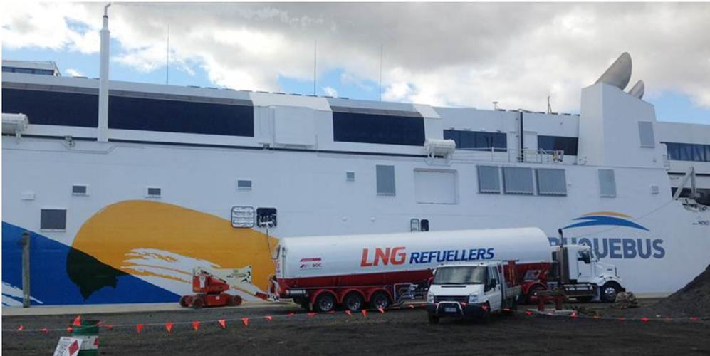
**Figure 4 - Exemple de ravitaillement de TTS direct sur un ferry rapide (Port de Buenos Aires)**
