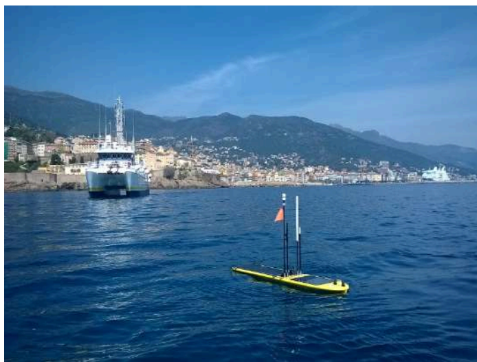
Figura 1: Il Wave Glider, veicolo autonomo marino di superficie, è uno strumento condiviso del Consorzio LAMMA e di IFREMER, e permette di misurare variabili dell'interfaccia aria-mare (moto ondoso, correnti dei primi strati, vento, parametri atmosferici e marini, variabili legate allo stato di contaminazione).
