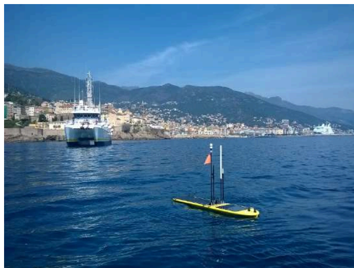
Figure 1: Le Wave Glider, un véhicule marin autonome de surface, est un instrument partagé par le Consortium LAMMA et
