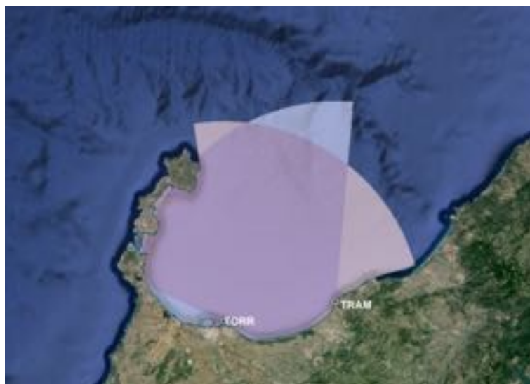
Figura / figure 9 Simulazione copertura radiale sistemi radar HF ARPA Sardegna / Simulation de la couverture radiale des systèmes radar HF ARPA Sardegna
