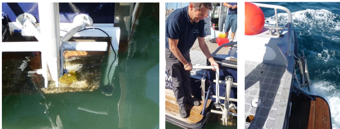
Figure 4 : Installation de la sonde sur le tableau arrière de la vedette (Essais pilotes du 03/10/2016)
