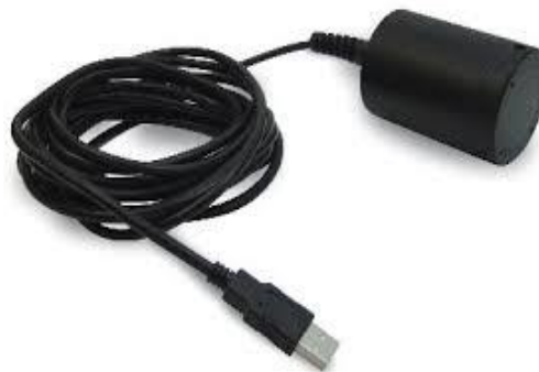
Fig.12 : Ecoscandaglio modificato per il progetto
