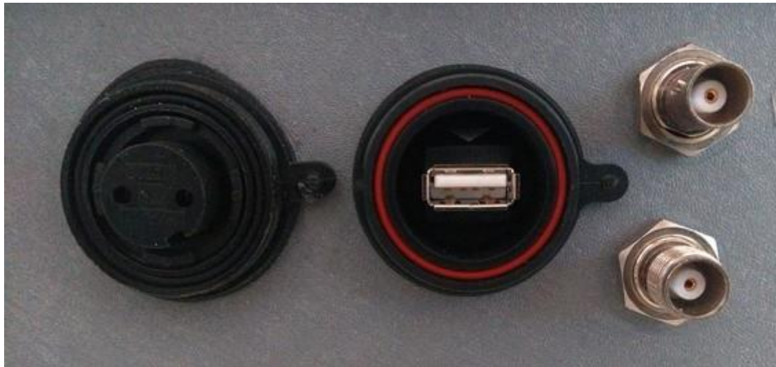
Fig.16 : Interfaccia di connessione dello strumento: 1 solo montaggio possibile
