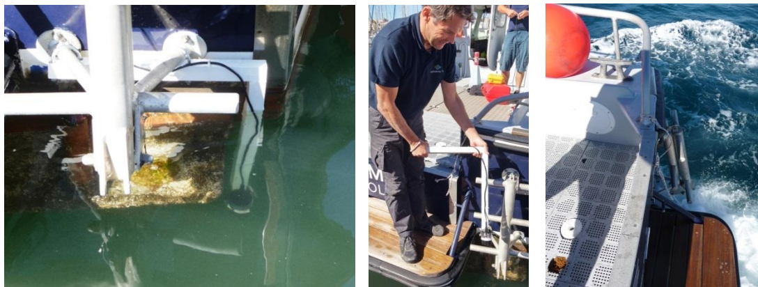
Figura 4 : Installazione del l'ecoscandaglio sullo specchio di poppa (prove pilota del 03/10/2016 )
