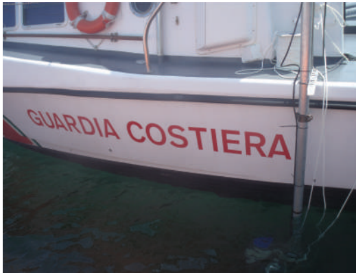
Fig. 71. Il palo di alluminio montato sulla motovedetta con l'ADCP (di colore blu) in acqua (a sinistra); l'interno della motovedetta con gli strumenti atti all'acquisizione dei dati di corrente e di posizione (a destra) / Le poteau en aluminium monté sur le bateau de patrouille avec l'ADCP (bleu) dans l'eau (à gauche); l'intérieur du bateau de surveillance avec des instruments pour l'acquisition des données de courant et de position (à droite)
