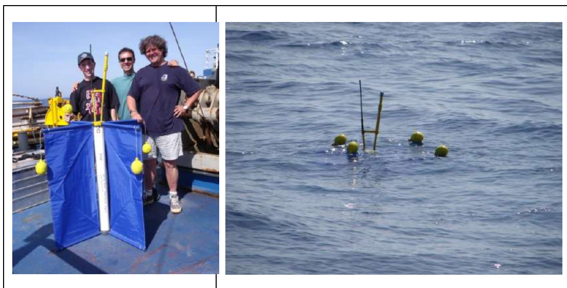
Fig.18: Una delle boe lagrangiane (o drifter) Technocean utilizzate negli esperimenti nelle Bocche di Bonifacio (a sinistra) e la stessa in acqua (a destra) / Une des bouées lagrangiennes (ou drifter) Technocean utilisées lors des expériences dans le Bocche de Bonifacio (à gauche) et les mêmes dans l'eau (à droite)
