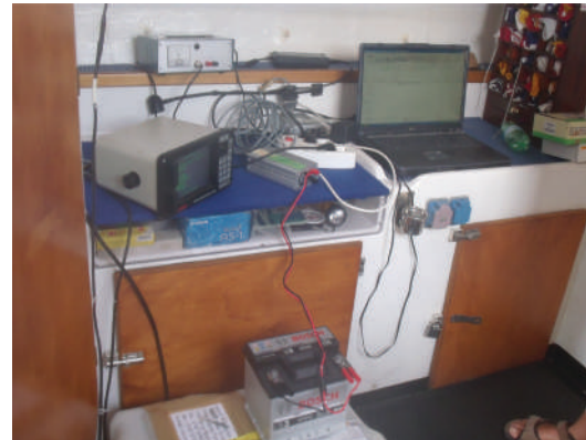
Fig. 71. Il palo di alluminio montato sulla motovedetta con l'ADCP (di colore blu) in acqua (a sinistra); l'interno della motovedetta con gli strumenti atti all'acquisizione dei dati di corrente e di posizione (a destra) / Le poteau en aluminium monté sur le bateau de patrouille avec l'ADCP (bleu) dans l'eau (à gauche); l'intérieur du bateau de surveillance avec des instruments pour l'acquisition des données de courant et de position (à droite)
