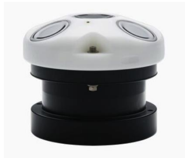
Figure 9 Compteur de courant AWAC 1 MHz et compteur d'ondes doppler.
