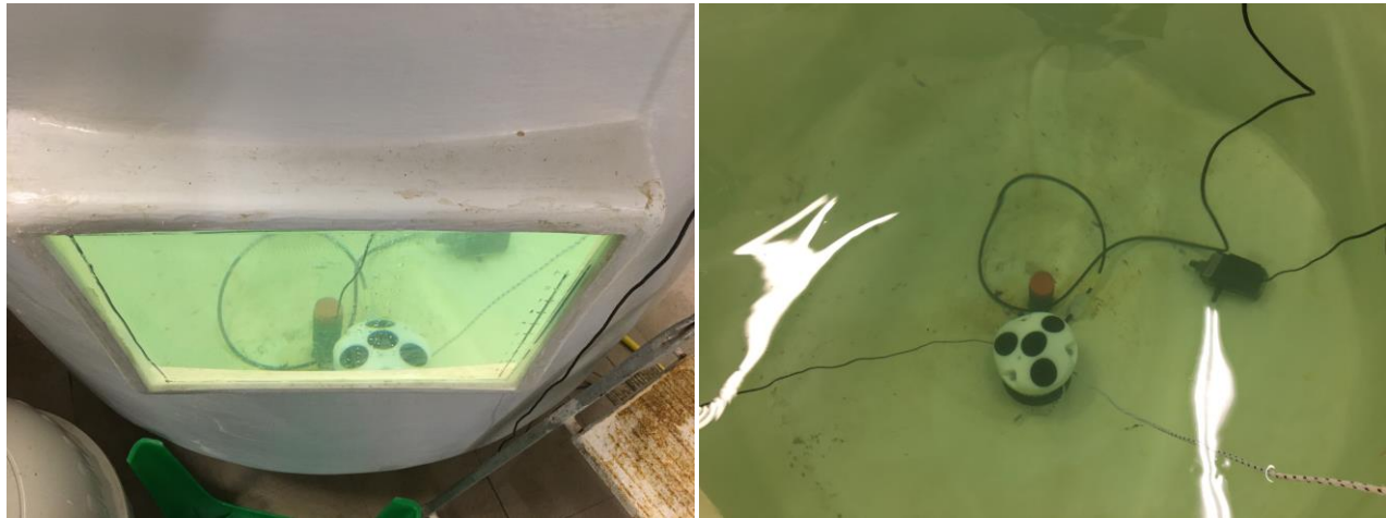
Figura 10 Posizionamento e funzionamento del correntometro AWAC in vasca
