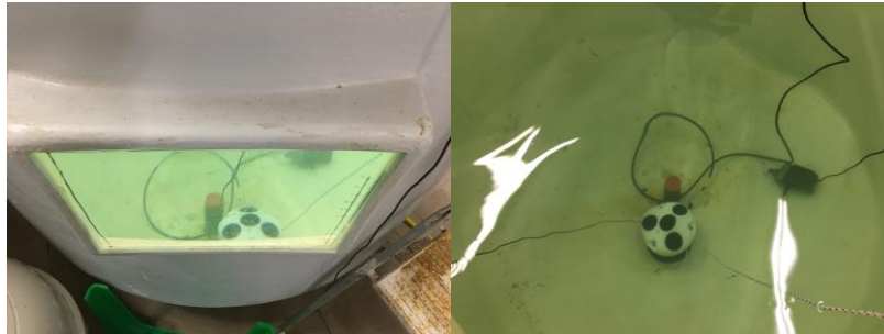
Figure 10 Positionnement et fonctionnement du compteur de courant AWAC dans le réservoir
